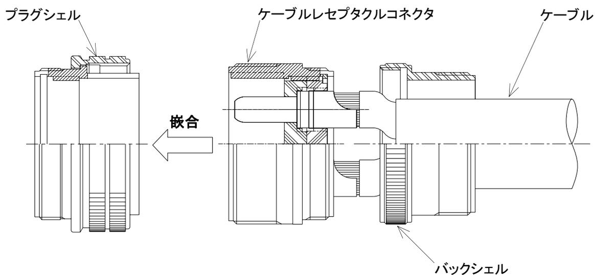
5-11. バックシェルとケーブルクランプボディを締め付けます。
